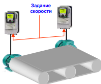
Рисунок 1.6 – Принцип выравнивания нагрузки.
