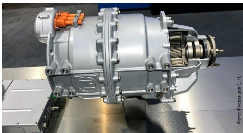
Рисунок 4.3 – Тяговый электродвигатель компании ZF.
