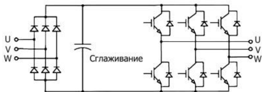
Рисунок 8.7 – Принципиальная схема преобразователя частоты для асинхронного электрического двигателя.
