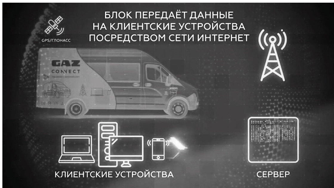
Рисунок 1.18 – Принцип действия GAZ Connect
