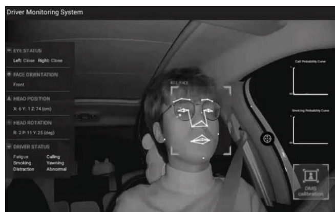
Рисунок 1.7 – Контроль системы Driver Monitor System
