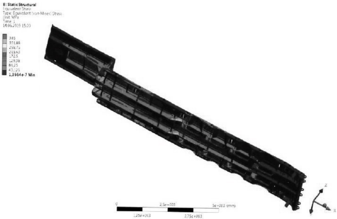
Рисунок 3.10 – Напряжения в раме 94184-30-1E вид снизу (схема №3)
