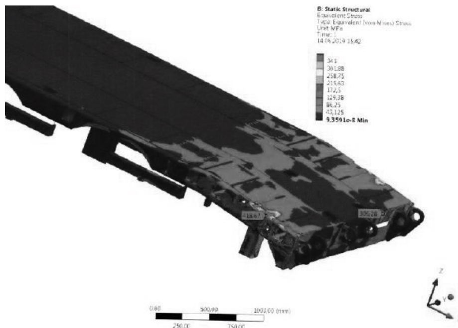
Рисунок 3.15 – Максимальное напряжение (418,67 МПа) в раме 94184-30-1Е Расчетная схема №3 (заезд техники)
