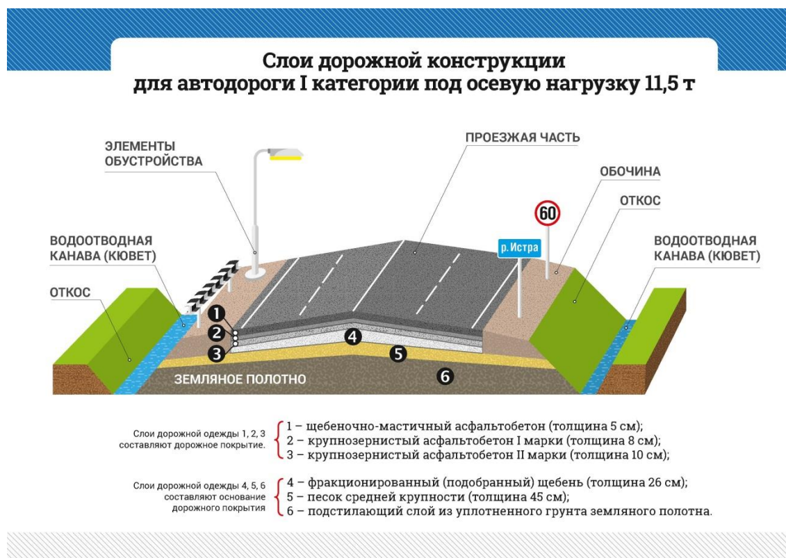
Рисунок 3 – Конструкция дорожной одежды
