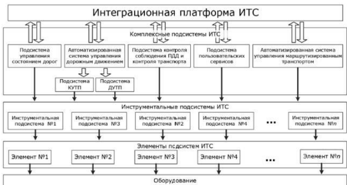
Рисунок 1.3 – Обобщенная схема физической архитектуры ЛП ИТС
