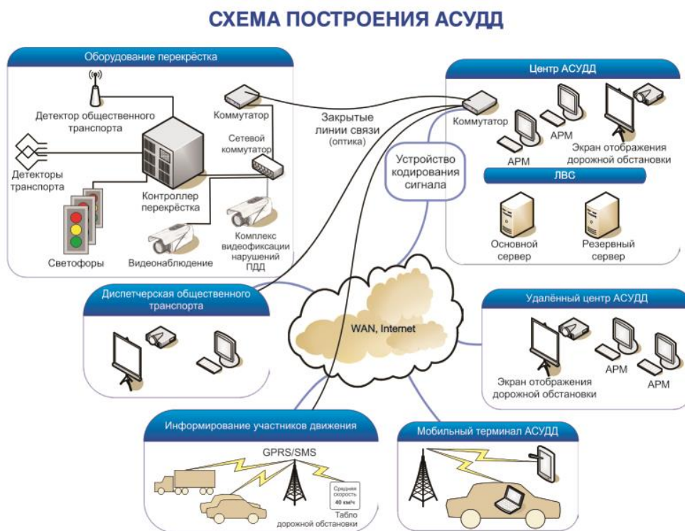
Рисунок 1.5 – Пример схемы построения АСУДД
