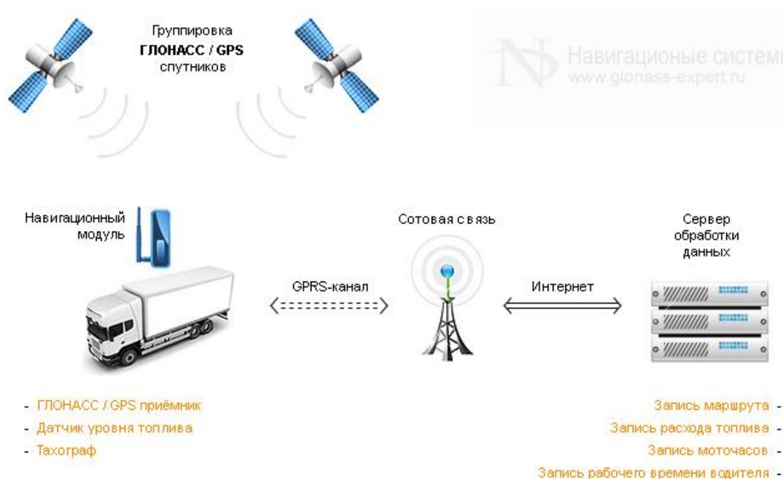
Рисунок 2.20 – Принцип работы системы ГЛОНАСС/GPS
