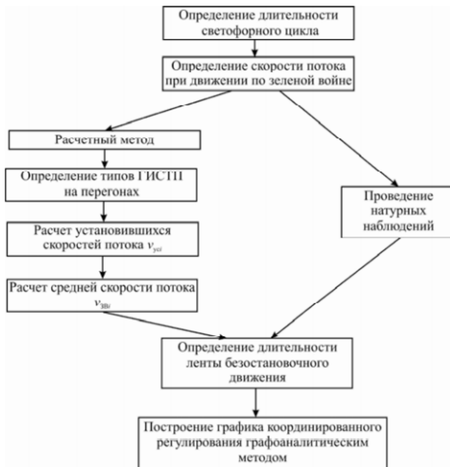
Рисунок 1.15 – Схема координированного управления
