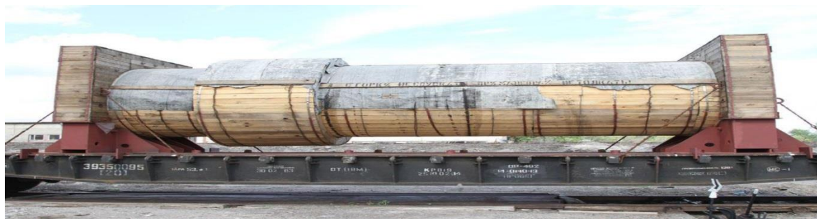
Рисунок 1 - Перевозка турбинного вала массой 96 т для Саяно-Шушенской ГЭС
