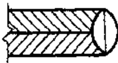
Рисунок 20 – Вид торцового шва
