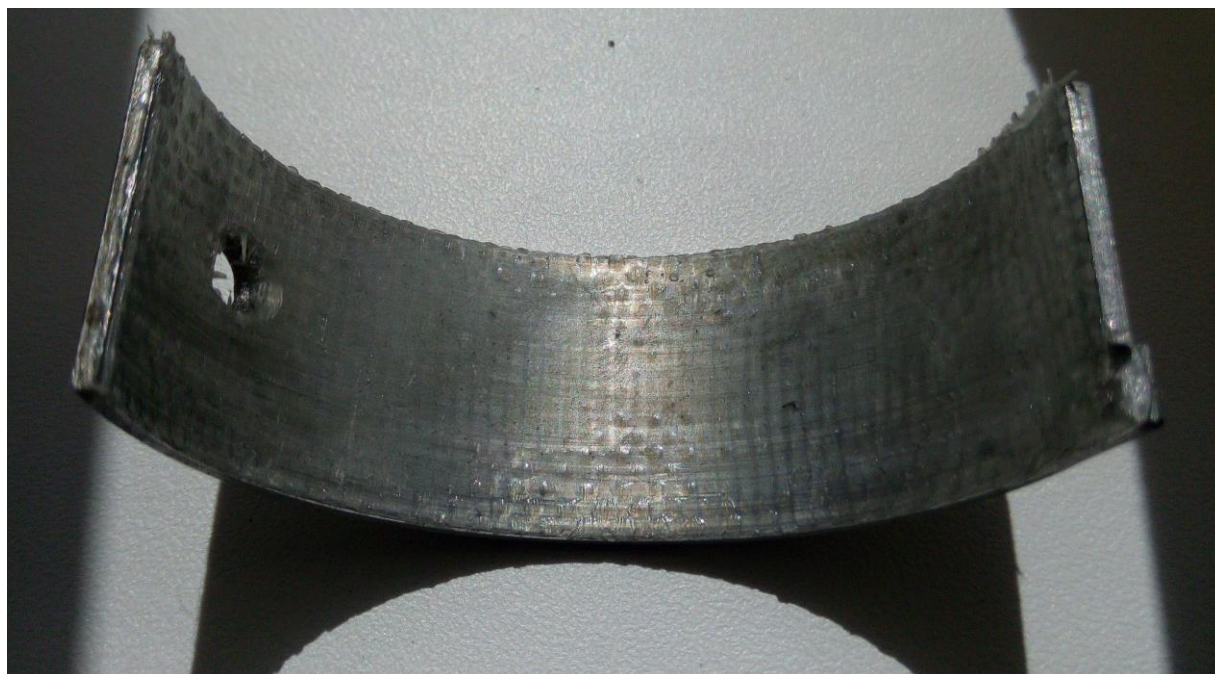
Рисунок 2.6 – Вкладыш с нанесённой и отвердевшей эпоксидной смолой ЭД-20
