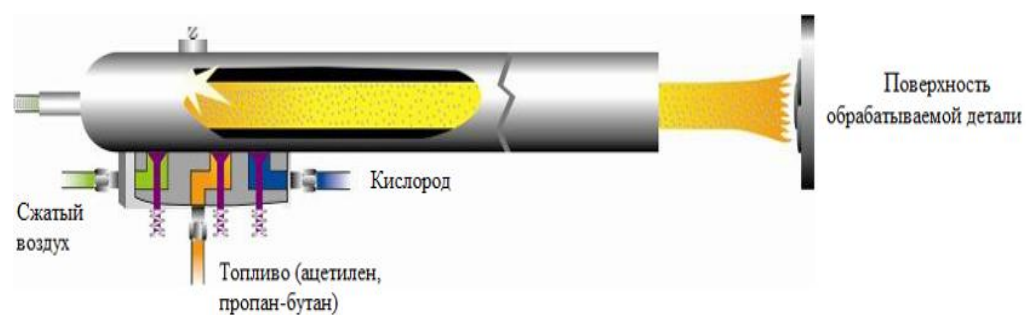
Рисунок 2.10 – Схема работы установки по детонационному напылению
