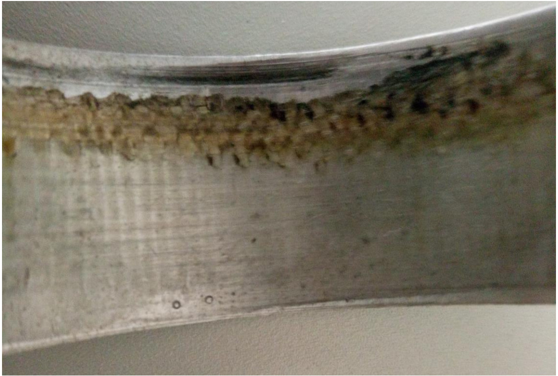
Рисунок 4.11 – Вкладыш с Эпоксидной смолой после испытаний
