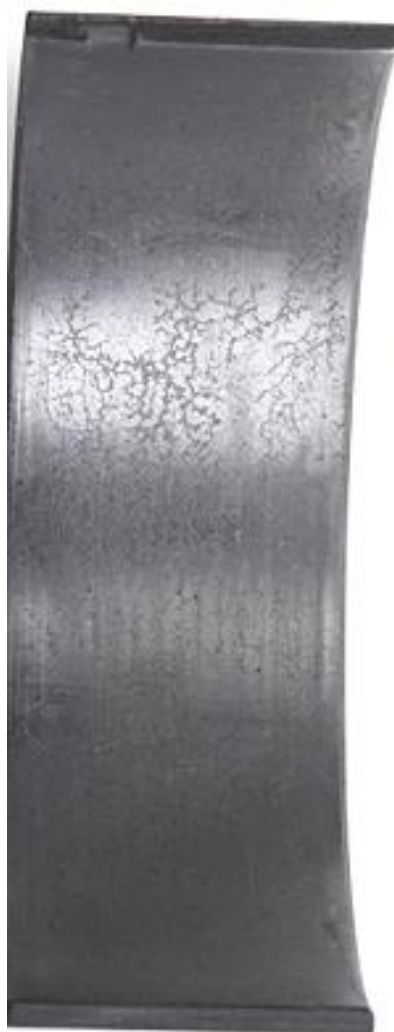
Рисунок 1.8 – Пример усталостного износа
