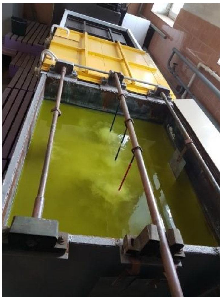
Рисунок 1.5 – Пример ванны для электрохимического обезжиривания
