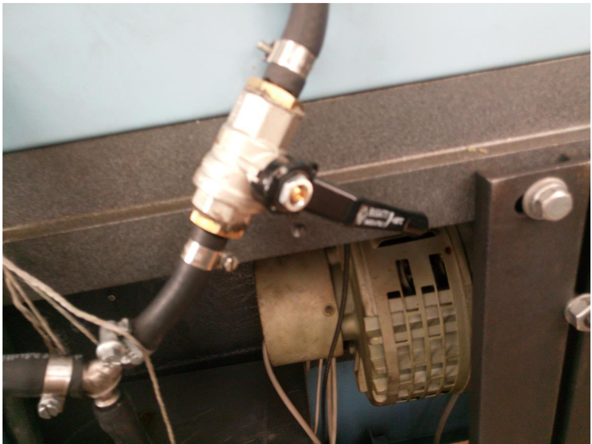
Рисунок 4.4 – Кран-регулятор подачи смазки в камеру трения
