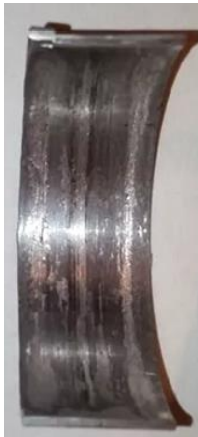
Рисунок 1.7 – Пример абразивного изнашивания
