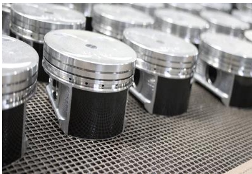
Рисунок 5.3 – Нанесённое покрытие на юбки поршня двигателя
