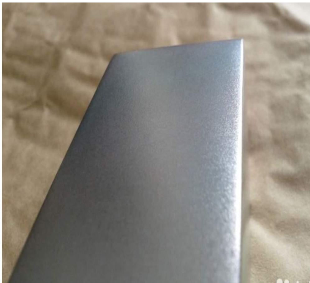
Рисунок 2.7 – Пример металлической поверхности после процесса анодирования
