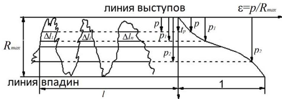
Рисунок 2.9 — Относительная опорная длина профиля, \varepsilon – относительное заглабление
