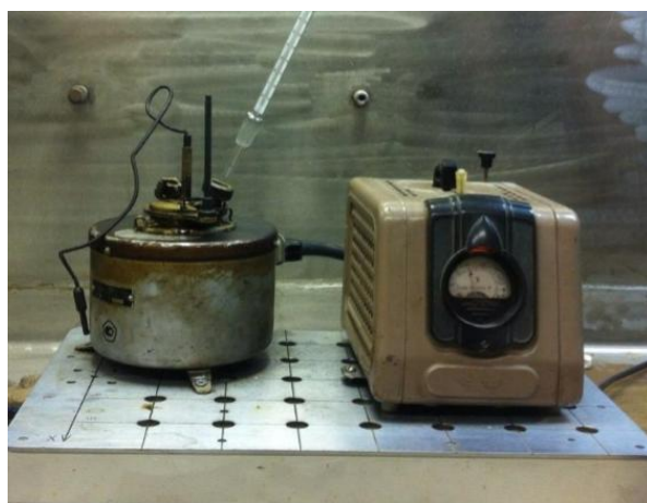
Рисунок 2.7 – Аппарат Пенски-Мартенса для определения температуры вспышки:
