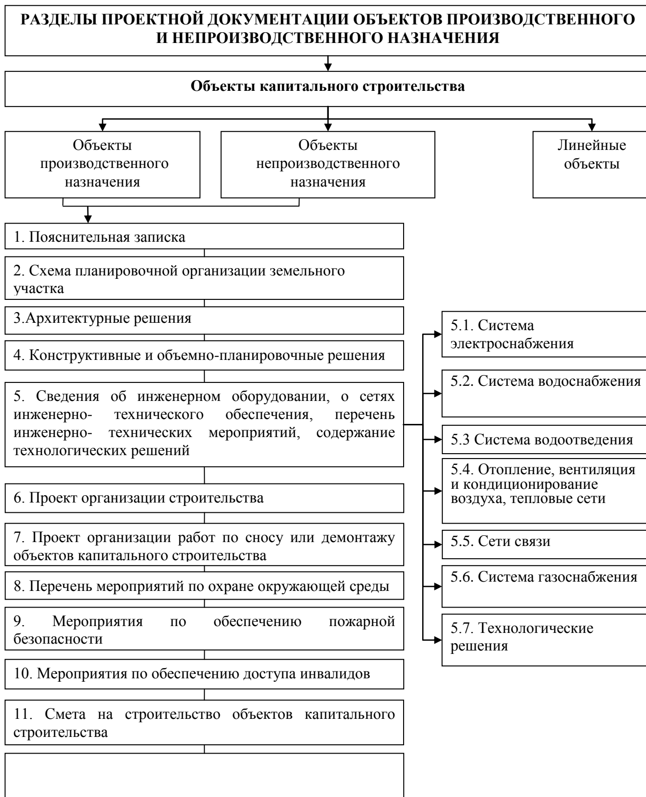
Рисунок 2 – Разделы проектной документации объектов производственного и непроизводственного назначения
