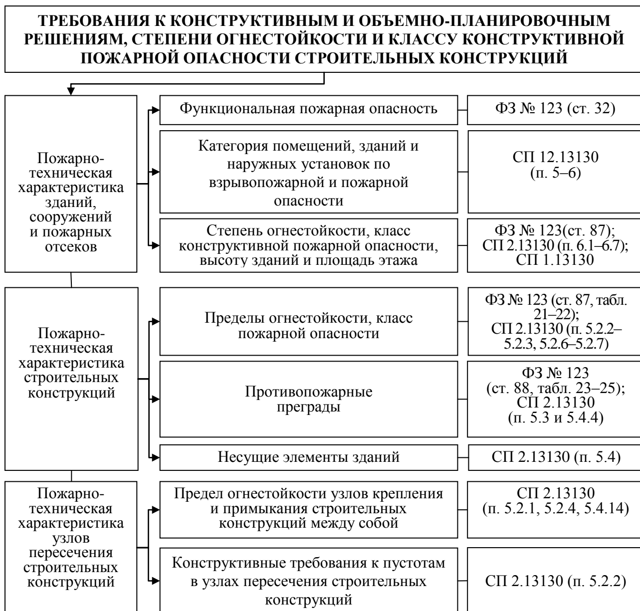
Рисунок 7 – Требования к конструктивным и объемно-планировочным решениям, степени огнестойкости и классу конструктивной пожарной опасности строительных конструкций
