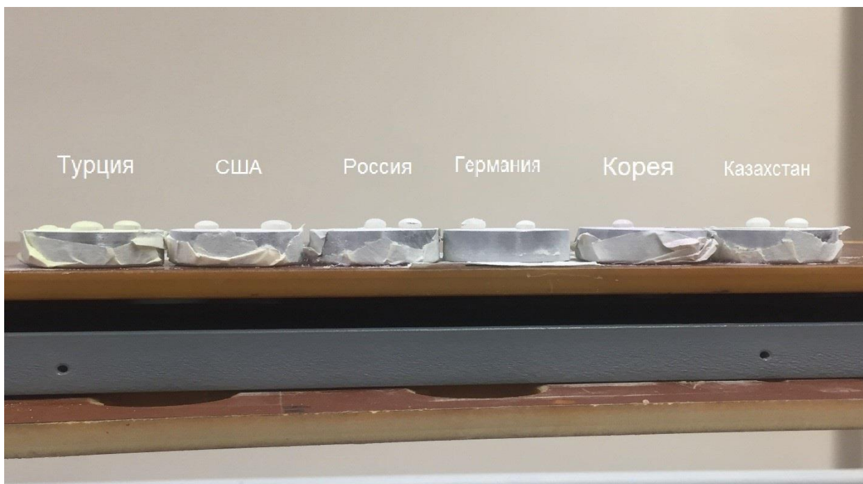
Рисунок 3.5 – Определение краевого угла смачивания ОПС
