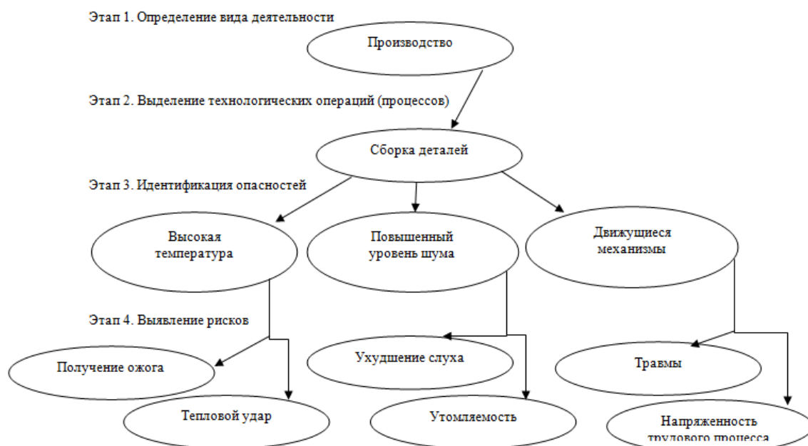
Рисунок 4 – Процесс идентификации опасностей и рисков, представленной в методике «УНИКС», на примере процесса сборки деталей
