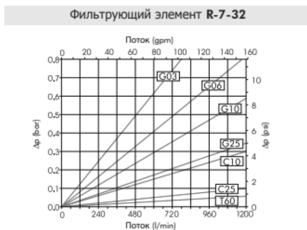
Рисунок 22 – Характеристики фильтра R-7-32
