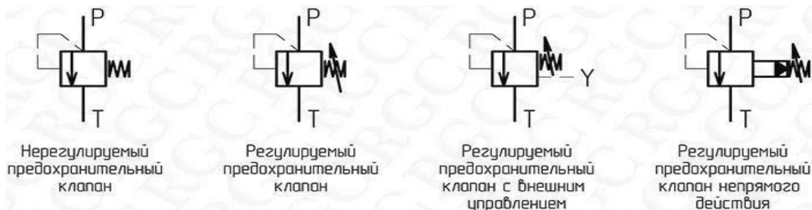
Рисунок 1 – Условные графические обозначения предохранительных клапанов
