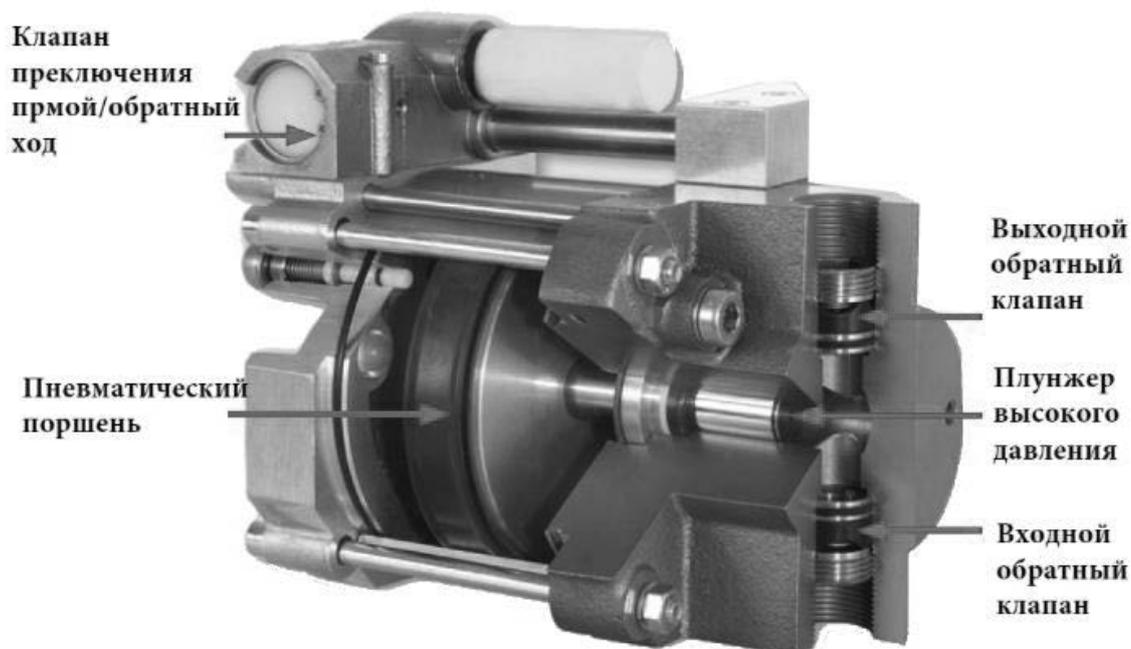
Рисунок 12. Пневмогидравлический мультипликатор
