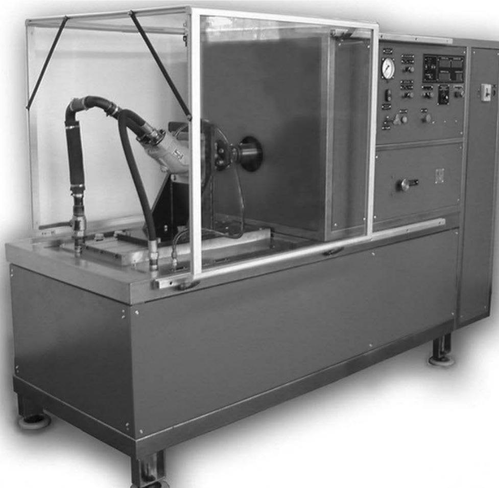
Рисунок 2 – Стенд для испытания насоса ОАО «Инкар».
