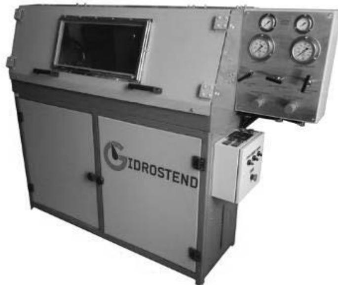
Рисунок 3 – Стенд для гидравлических и пневматических испытаний деталей трубопроводов
