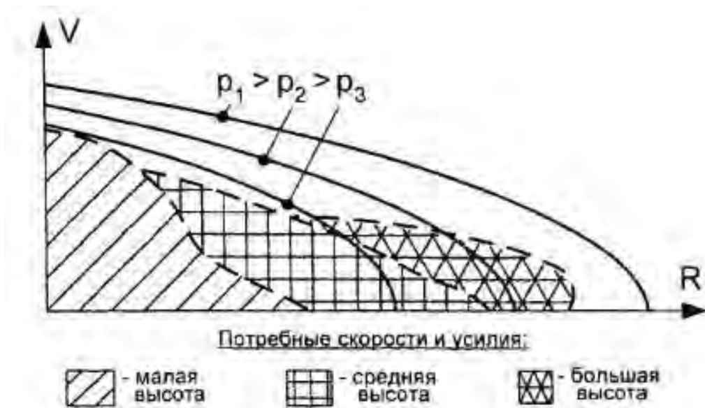
Рисунок 2.7. Механические характеристики рулевого привода при изменении давления питания в полете
