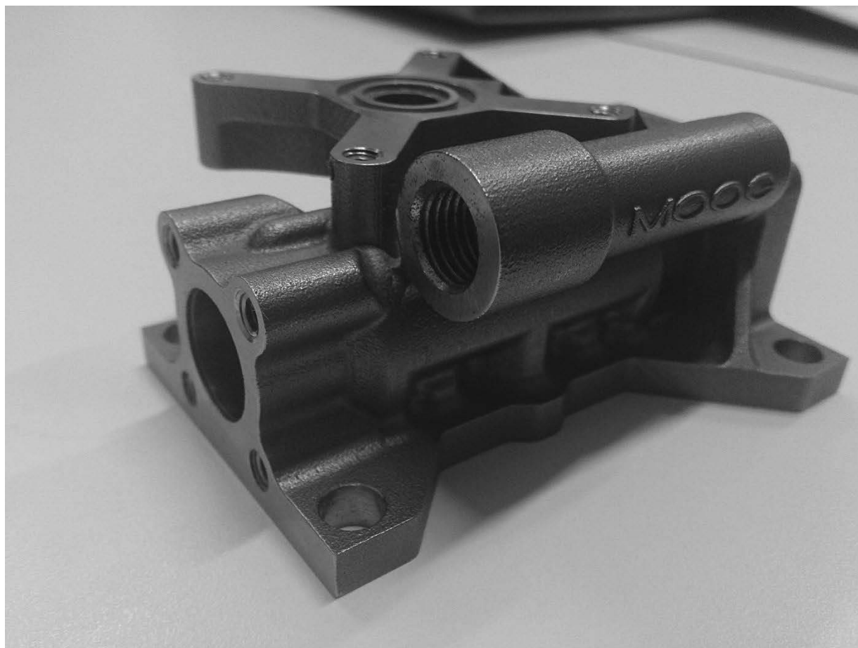
Рисунок 2.10. Деталь фирмы Moog изготовленная с помощью аддитивных технологий.
