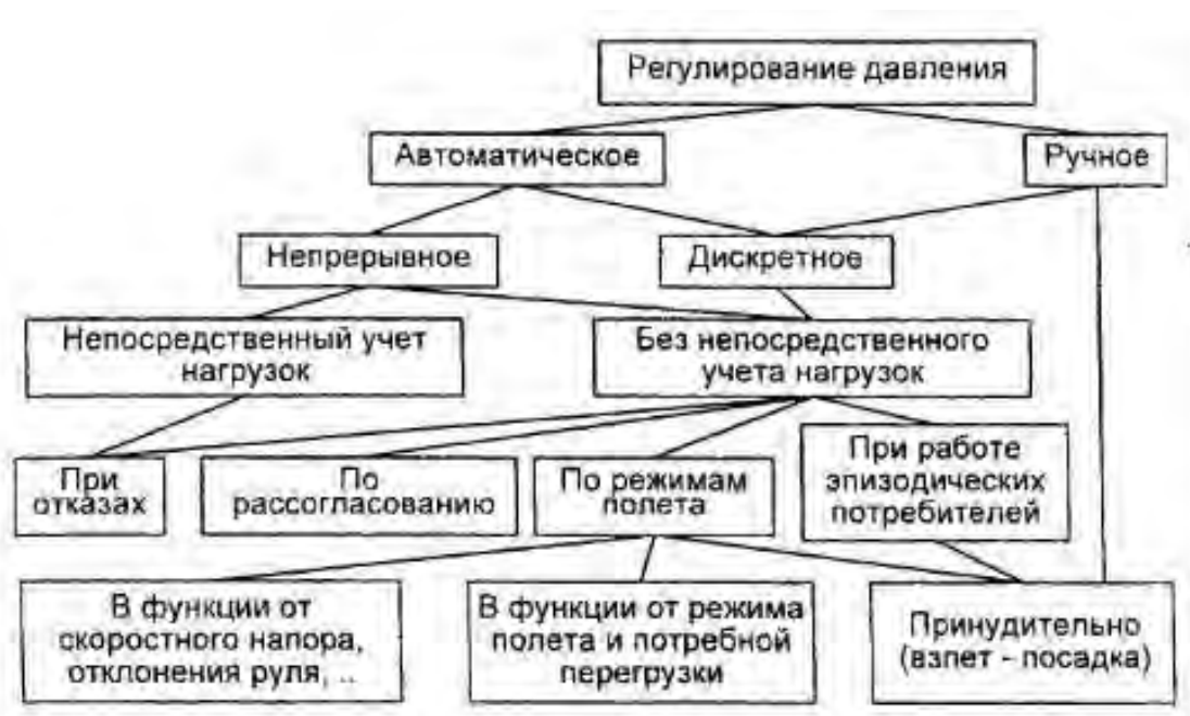
Рисунок 2.8. Принципы регулирования давления в гидросистеме
