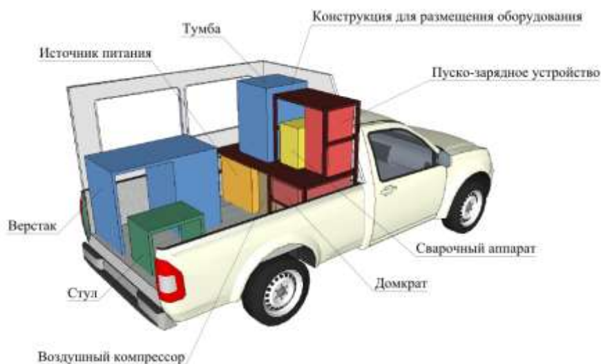
Рисунок 3.5 – Компоновка оборудования внутри кузова
