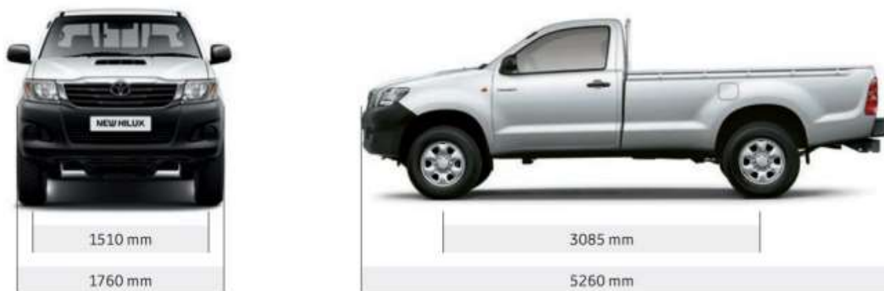
Рисунок 2.2 – Габаритные размеры автомобиля Toyota Hilux Single Cab
