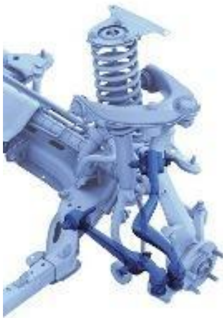
Рисунок 2.3 – Многорычажная независимая подвеска
