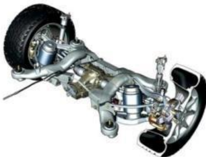
Рисунок 2.5 – Подвеска типа «Де Дион»
