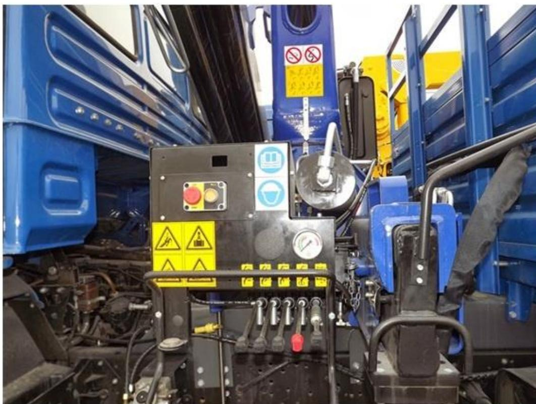
Рисунок 2.5 – Типичная система управления КМУ
