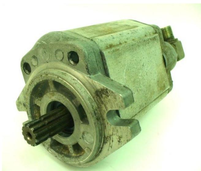
Рисунок 3.1 – Насос гидравлический Shimadzu 20A32L (вид 1)
