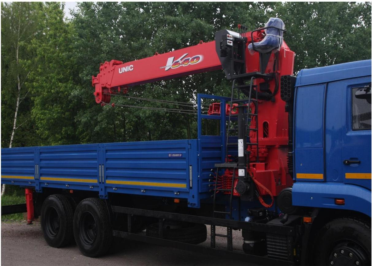
Рисунок 1.3 – КМУ на грузовом автомобиле (вариация 1)
