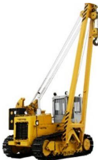
Рисунок 1.3 – Трубоукладчик ЧЕТРА ТГ302
