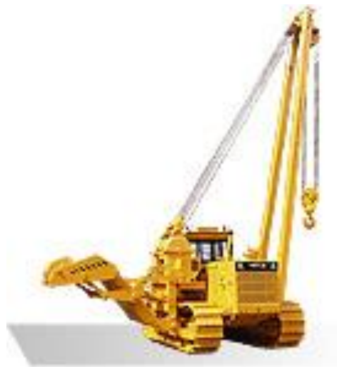
Рисунок 1.5 – Трубоукладчик ЧТЗ-Уралтрак ТР-12.22.01
