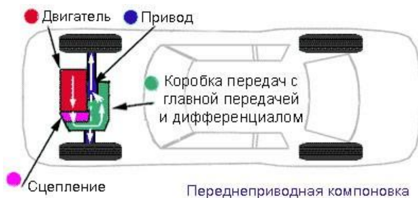
Рисунок 2 – Устройство системы переднего привода
