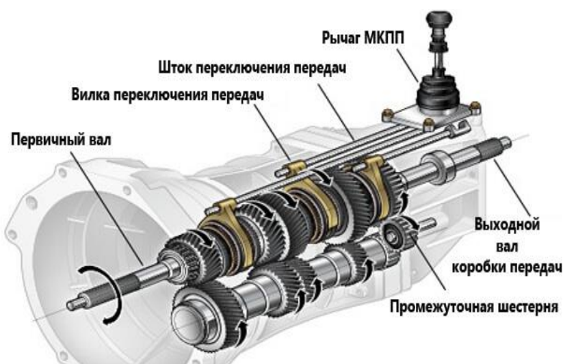
Рисунок 5 – Схема механической коробки передач
