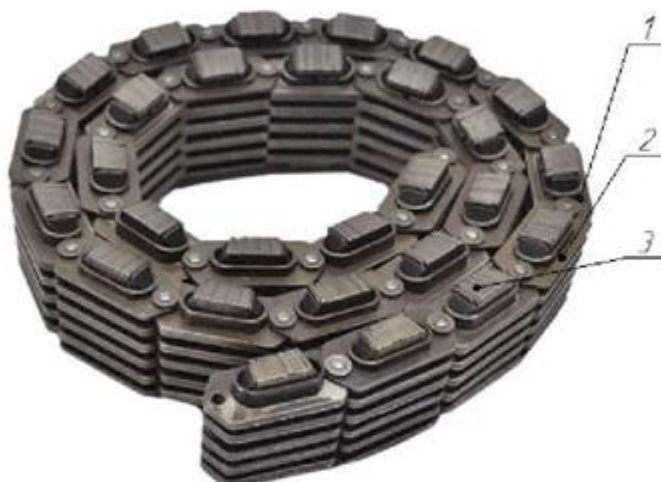
Рисунок 1.14 – Вариаторная цепь: 1 – внутренние элементы; 2 – внешние элементы; 3 – фрикционные накладки
