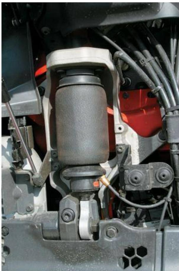
Рисунок 1.6 – Пневматическая подвеска кабины грузового автомобиля Scania
