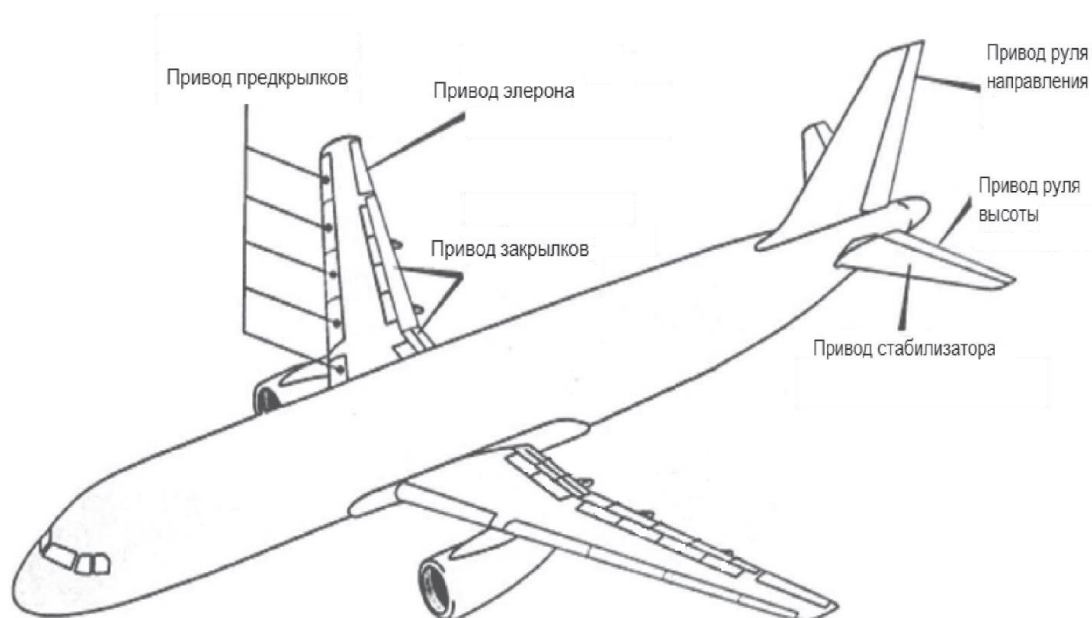
Рисунок 1.1 – Аэродинамические поверхности для управления полетом магистрального самолета
