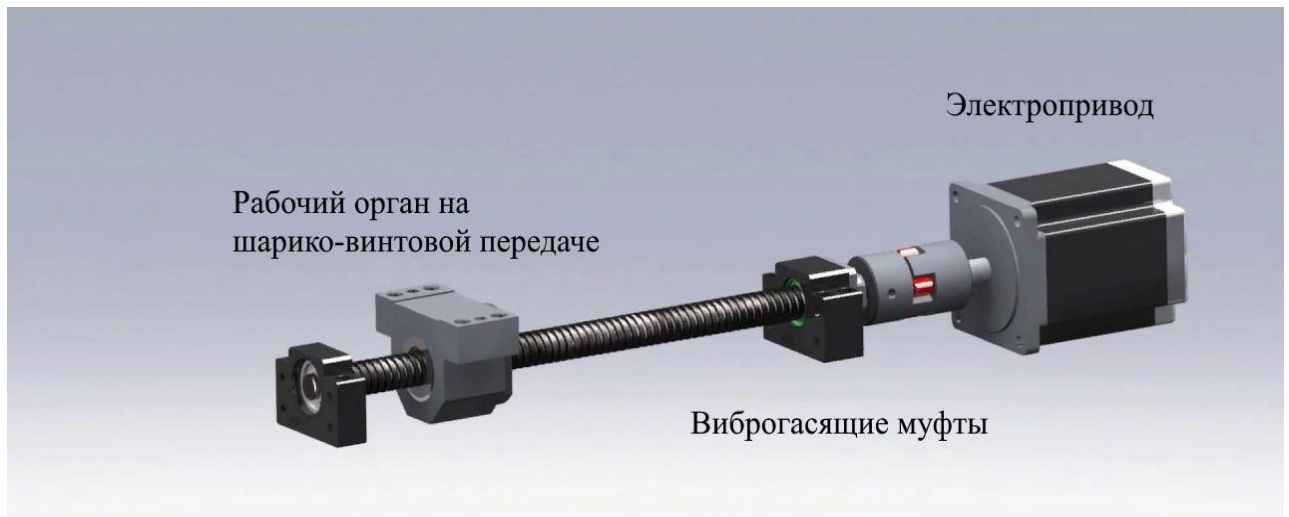
Рис. 1.3 - Модель электропривода и рабочего органа
