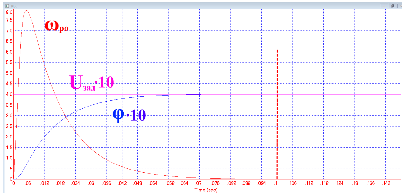
Рис. 5.10 – Диаграмма работы привода при старт-стопном управлении
