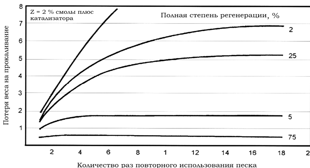
Рисунок 4.5 – Потери веса на прокалывание как функция количества циклов при различных степенях регенерации, итого r %. Для иллюстрации даётся формовочная смесь с 2 % смолы и органического катализатора
