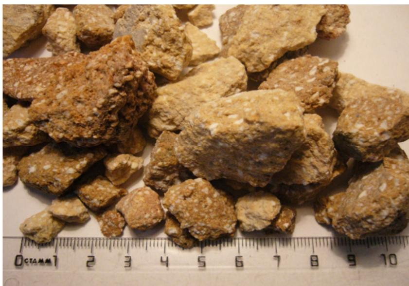
Рисунок 4.4 – Динас, измельченный в щековой дробилке
