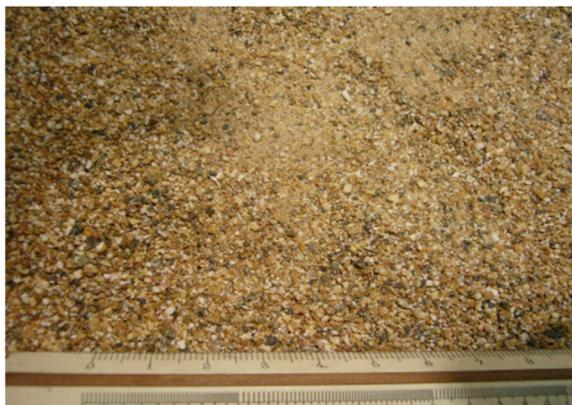
Рисунок 4.5 – Динас после конусной дробилки
