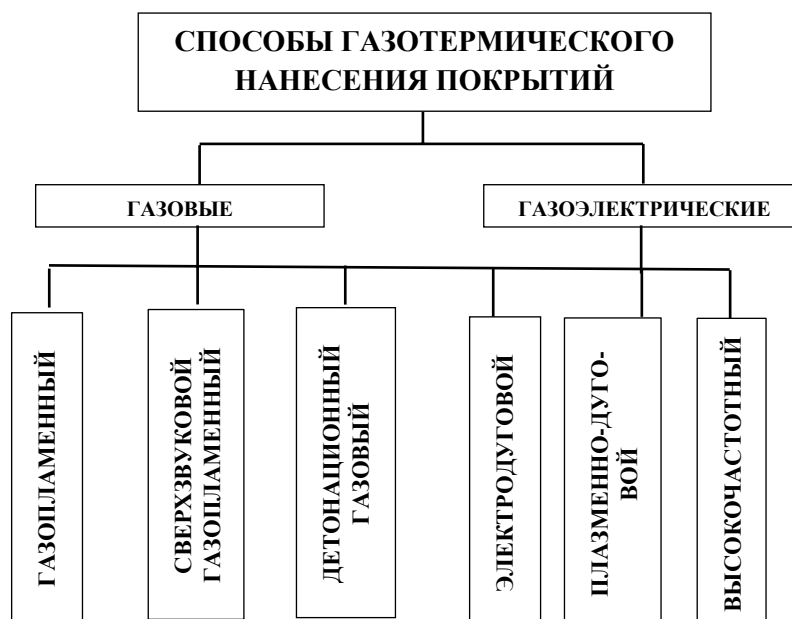
Рисунок 1.2 – Классификация методов газотермической обработки на основе энергетических характеристик
