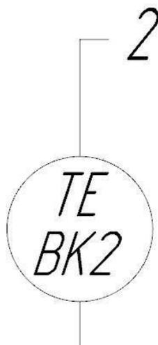
Рисунок 2.7. Обозначение датчика на схеме автоматизации
