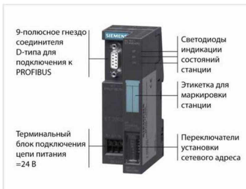
Рисунок 2.21. Модуль Siemens ET200S
