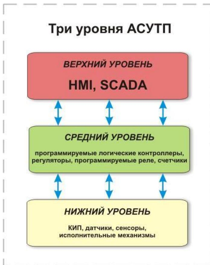
Рисунок 2. Иерархическая структура системы автоматизации
