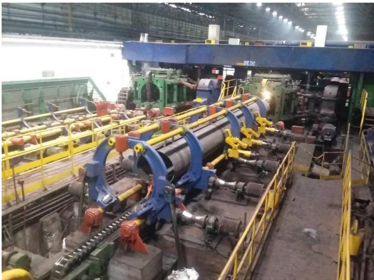
Рисунок 1.1. Сборочное устройство и станы технологической сварки
