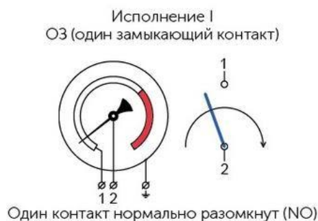
Рисунок 2.2. Схема срабатывания датчика ДМ2010
