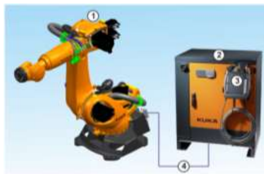
Рисунок 16. Мехатронная система, состоящая из: 1 – манипулятор; 2 – контроллер робота; 3 – планшет; 4 – соединительные кабели
