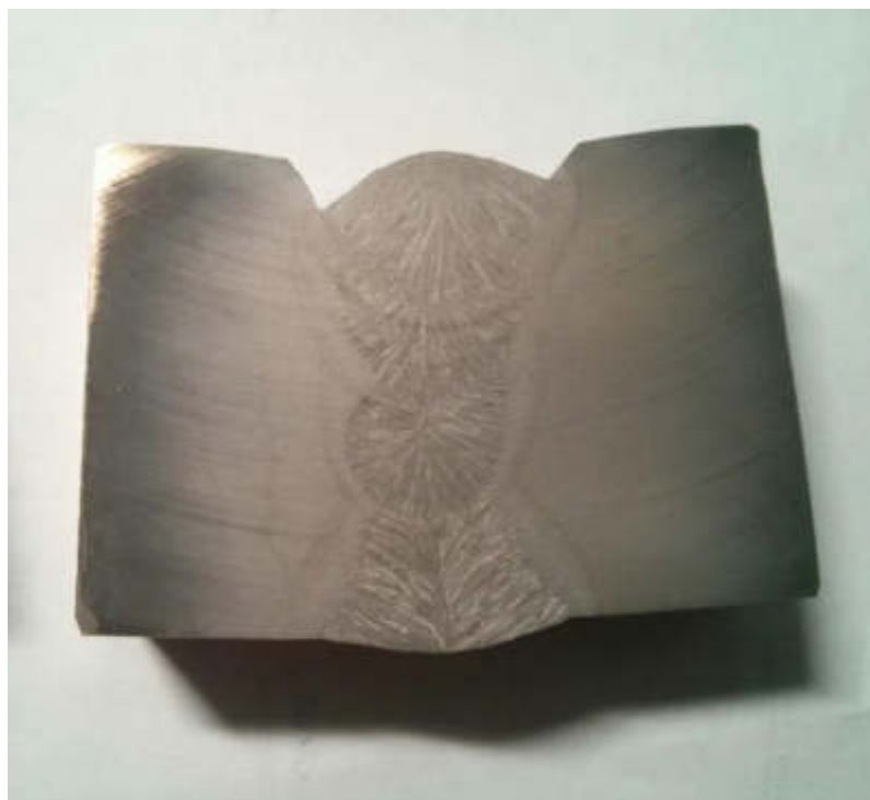
Рисунок 3.23 – Макрошлиф наружного шва (4-ой проход)
