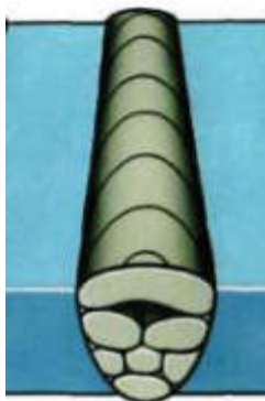
Рисунок 4.9 – Изображение межваликового несплавления
