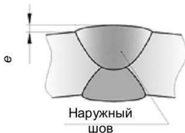
Рисунок 2.4. Наружный сварной шов в сечении
