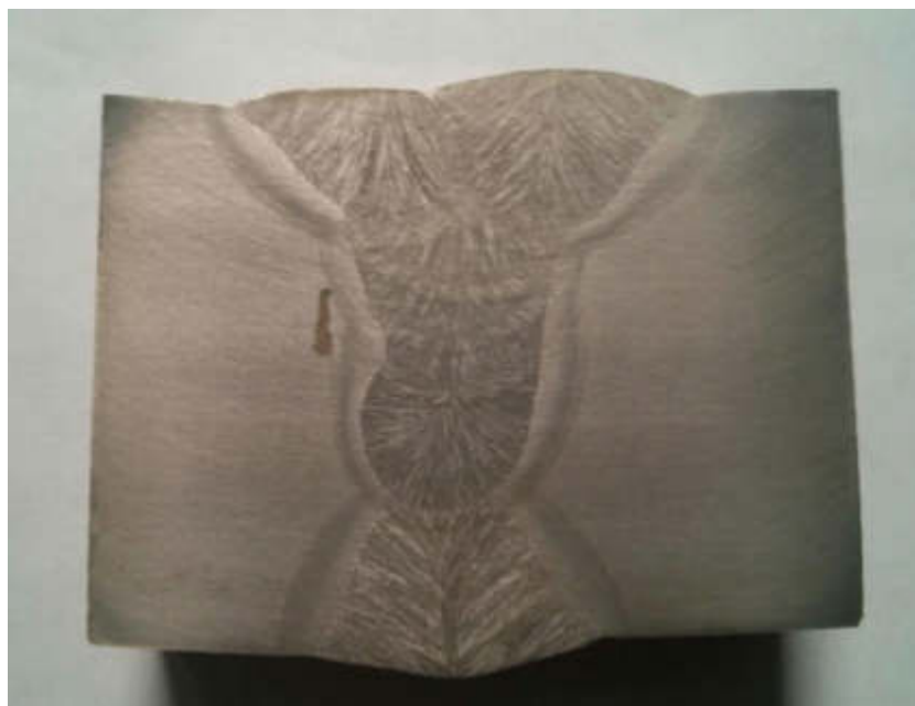
Рисунок 3.25 – Макрошлиф наружного шва (6-ой проход)
