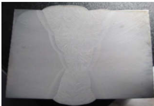
Рисунок 3.14– Шлиф после сварки с применением четырех дуг
