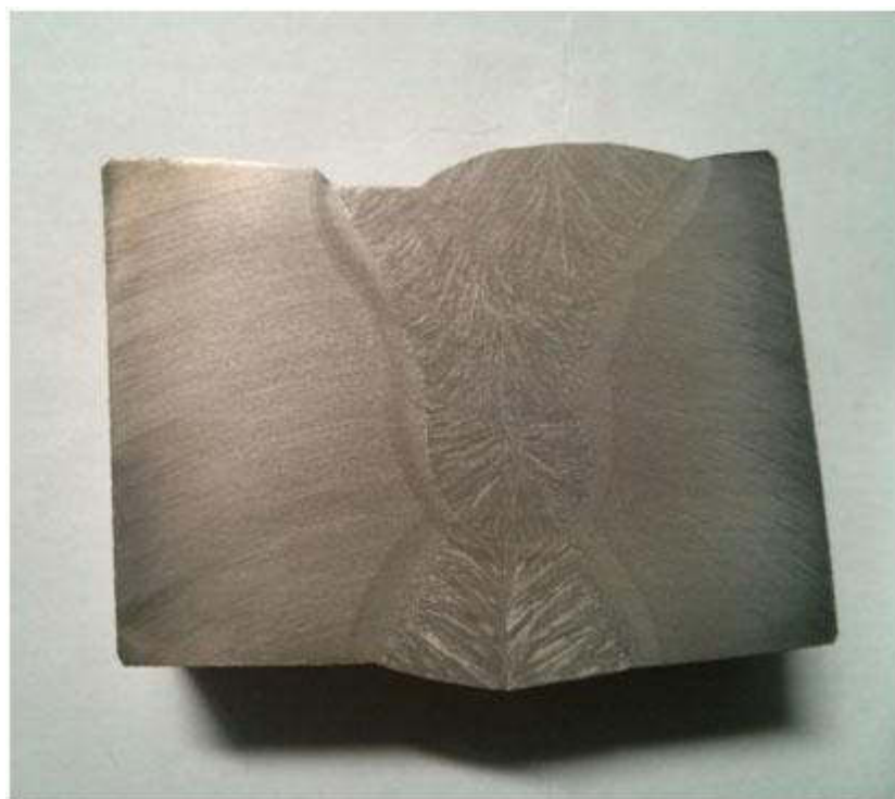
Рисунок 3.24 – Макрошлиф наружного шва (5-ой проход)
