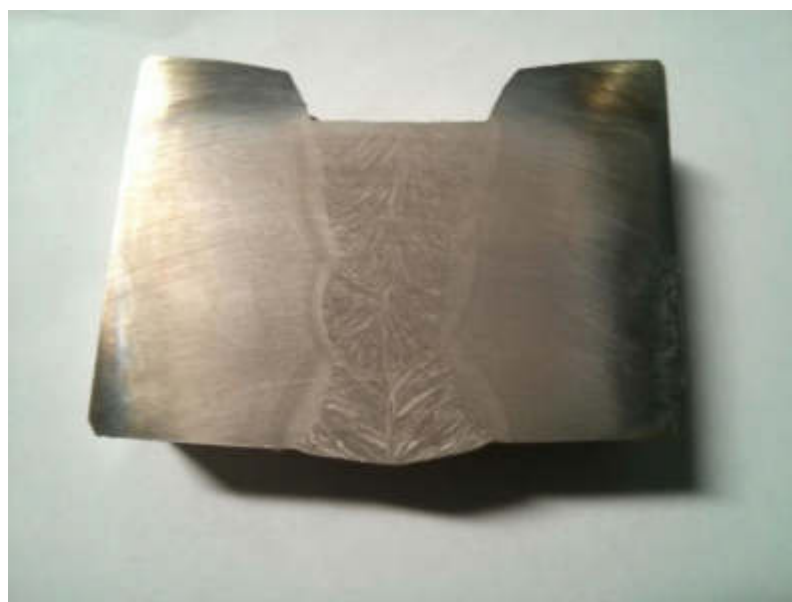
Рисунок 3.22 – Макрошлиф наружного шва (3-ой проход)
