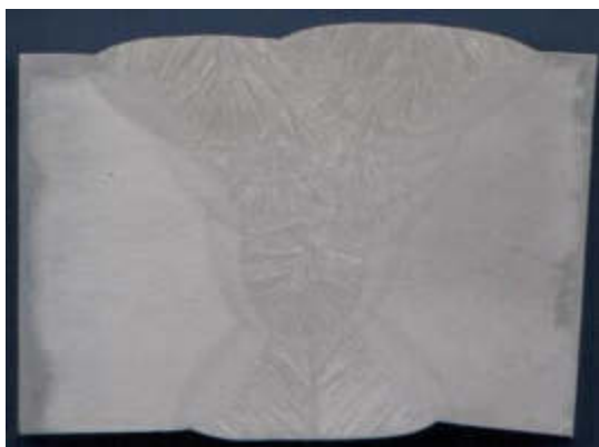
Рисунок 3.17 – Шлиф после сварки с применением четырех дуг
