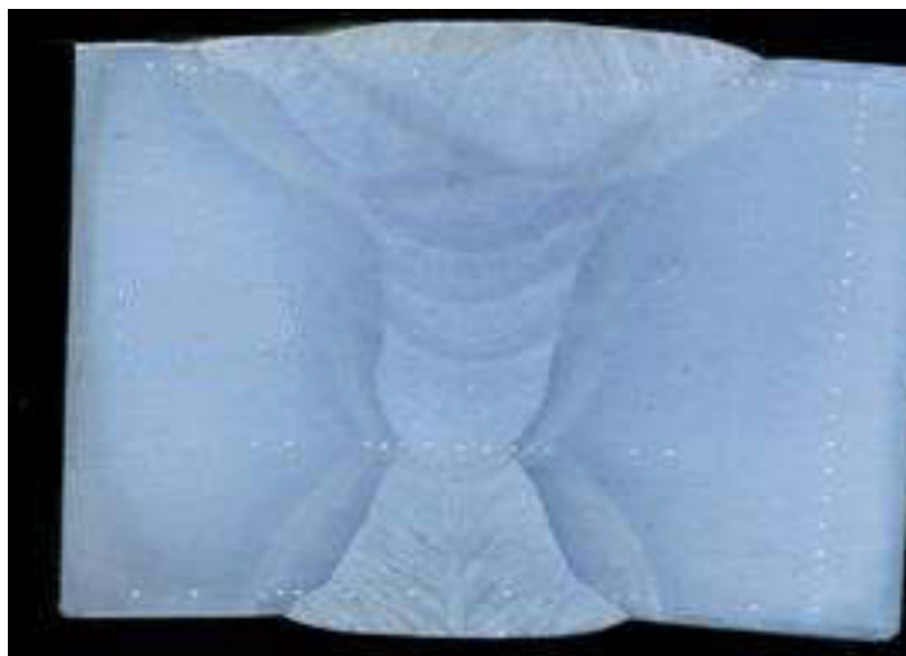
Рисунок 3.27 – Шлиф после сварки с применением четырех дуг
