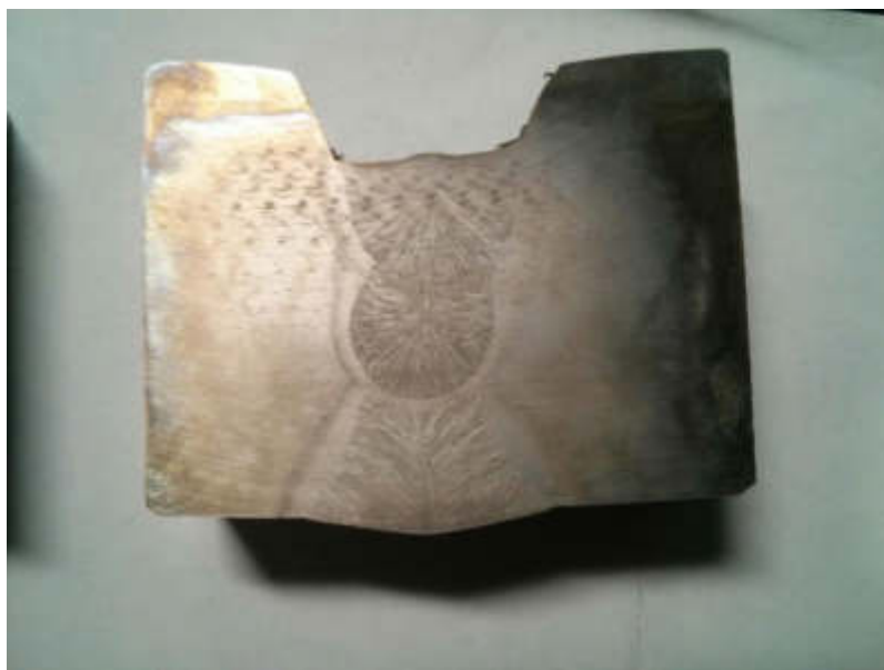
Рисунок 3.21 – Макрошлиф наружного шва (2-ой проход)
