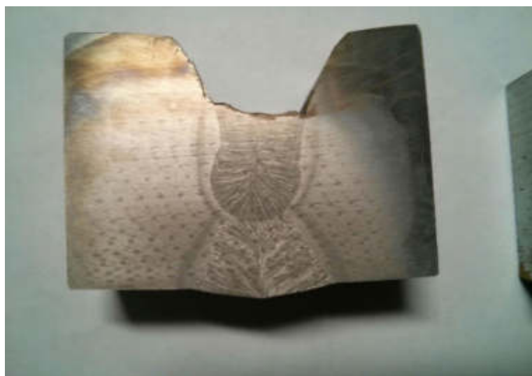
Рисунок 3.20 – Макрошлиф внутреннего и наружного (1-ый проход) швов
