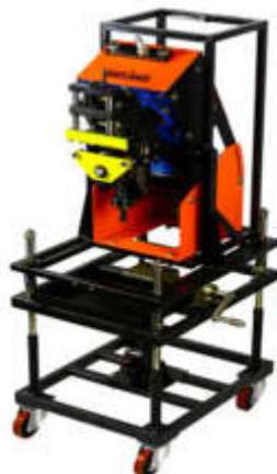
Рисунок 2.3 – Кромкоскалывающая машина МКС-18У
