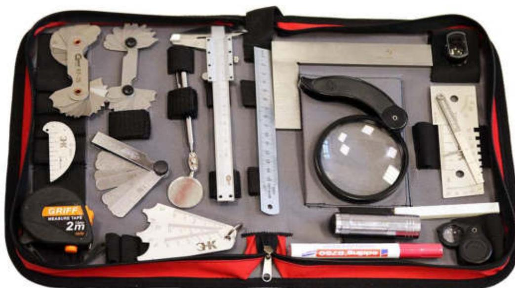
Рисунок 3.1 – Общий вид комплекта для ВИК.
