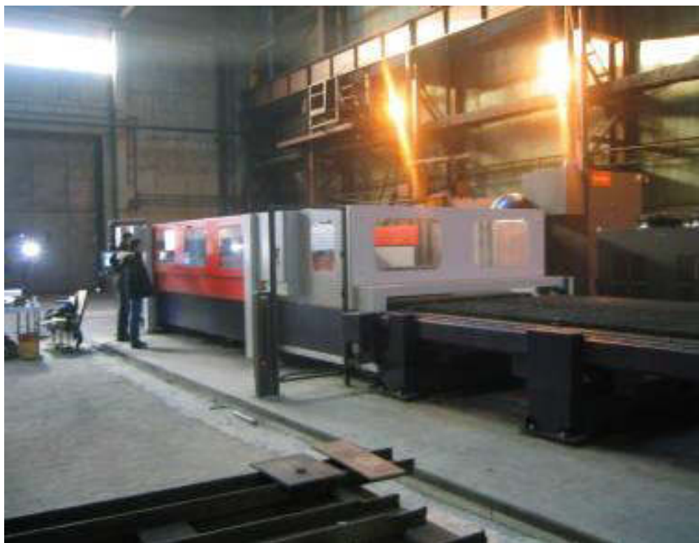
Рисунок 2.2 – Лазерный комплекс Bystar 8025
