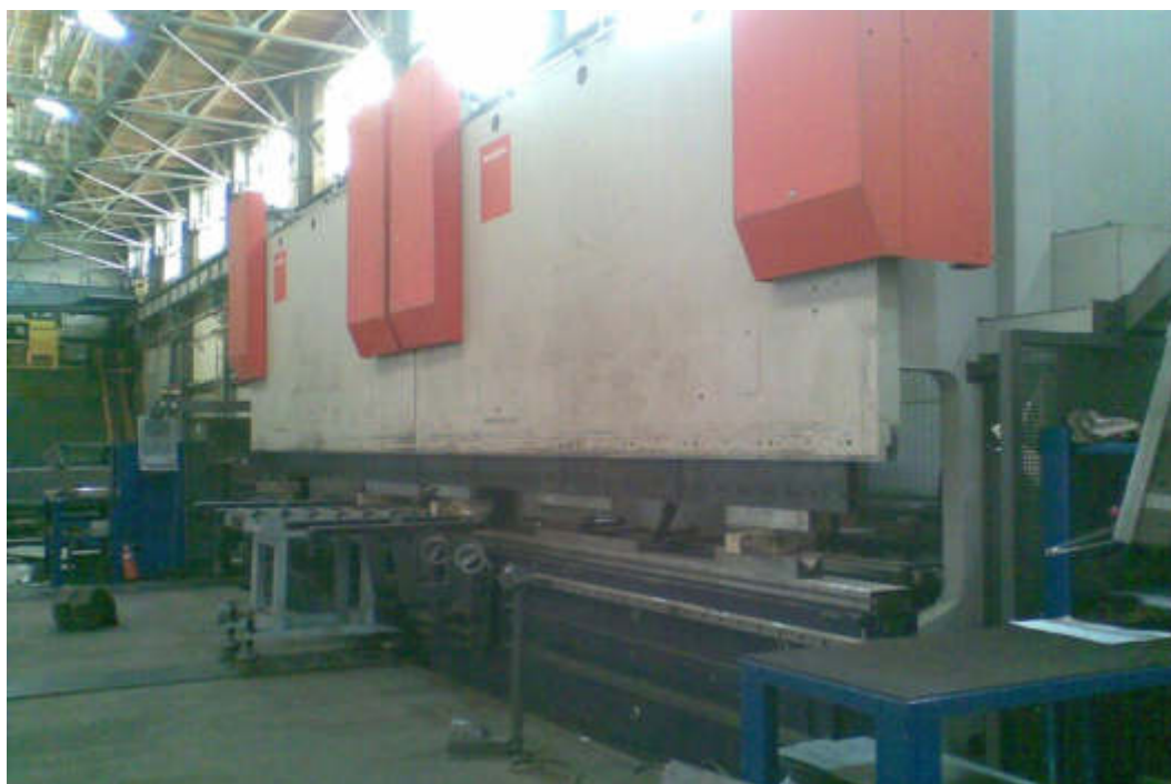
Рисунок 2.4 – листогибочный комплекс Beyeler PR 10 400 IPC
