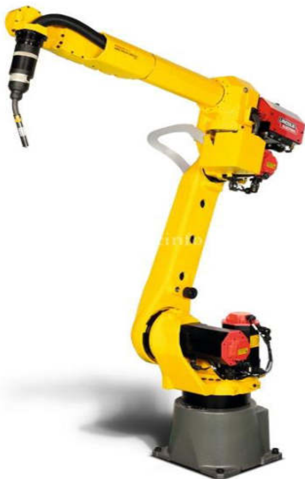
Рисунок 2.24 – Робот для дуговой сварки ARC MATE 120iC/12L
