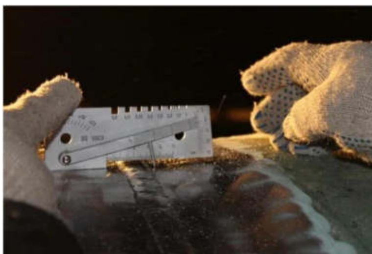
Рисунок 3.2 – Измерительный контроль с помощью шаблона УШС -3
