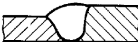
Рисунок 1.4 – Плавный переход при сварке листов разной толщины
