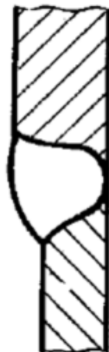
Рисунок 1 – Плавный переход при сварке листов разной толщины
