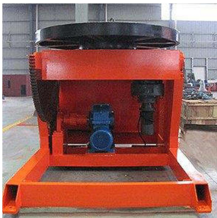
Рисунок 2.14 – Расположение электродвигателя и общий вид поворотного
