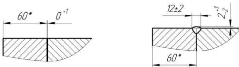
Рисунок 2.14 – Общий вид сварного шва №4
