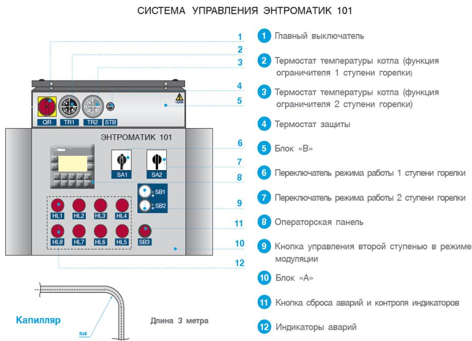
Рисунок 8.1 – Общий вид системы автоматизации «ЭНТРОМАТИК 101»
