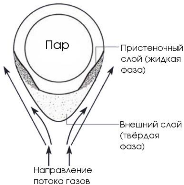
Рисунок 4.2 – Схематичное изображение среза трубы
