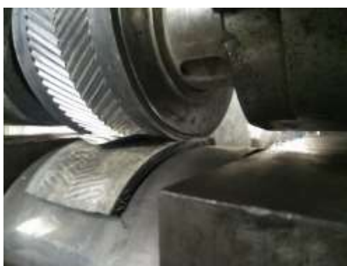
Рисунок 27. Процесс появления замятия.
