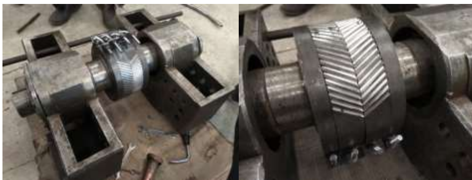
Рисунок 23. Собранный валковый узел.
