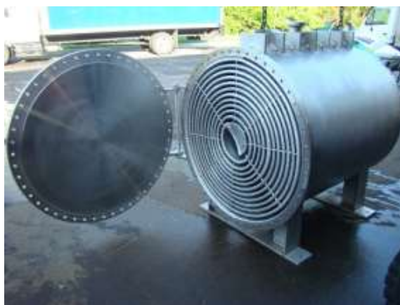
Рисунок 8. Спиральный теплообменник российского производства.
