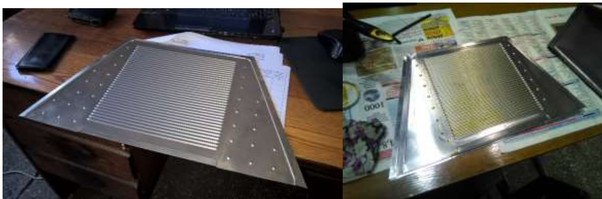
Рисунок 11. Пластины рекуператора полученные вытяжкой эластичной средой.
