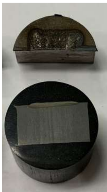
Рисунок 5.9 – Шлиф после лазерной наплавки порошкового материала для металлографического исследования
