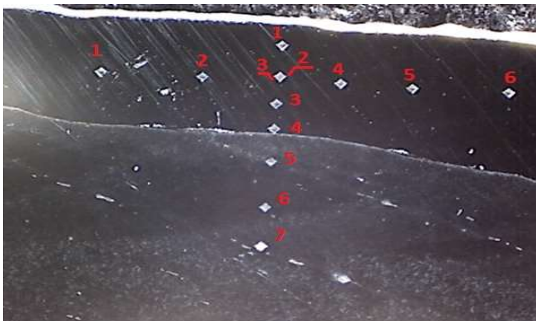
Рисунок 4.20 – Схема измерения микротвердости (x50)
