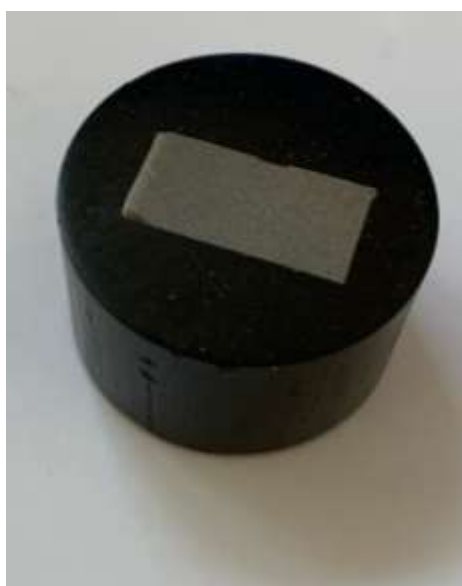
Рисунок 6.2 – Шлиф с детонационным напылением для металлографического исследования
