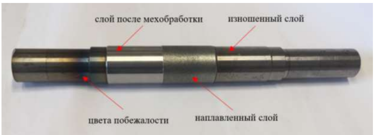
Рисунок 4.23 – Валок для холодной наплавки с тремя зонами поверхности
