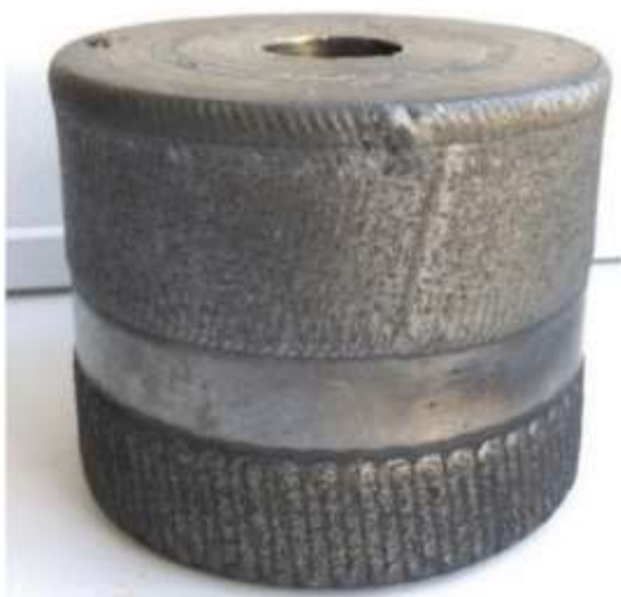
Рисунок 4.13 – Цилиндрический образец для отработки геометрии после наплавки
