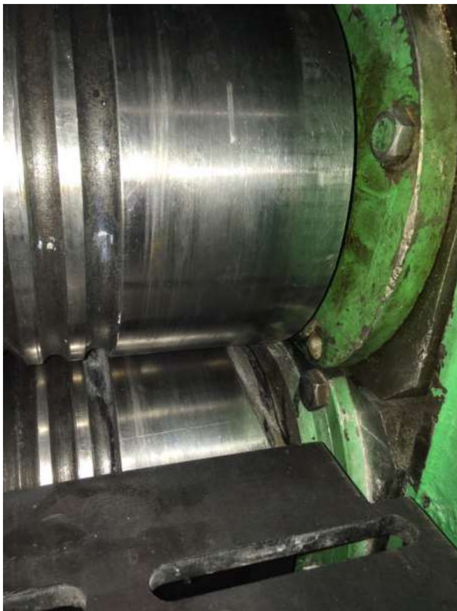
Рисунок 1.3 – Разрушенная рабочая часть бочки прокатного валка
