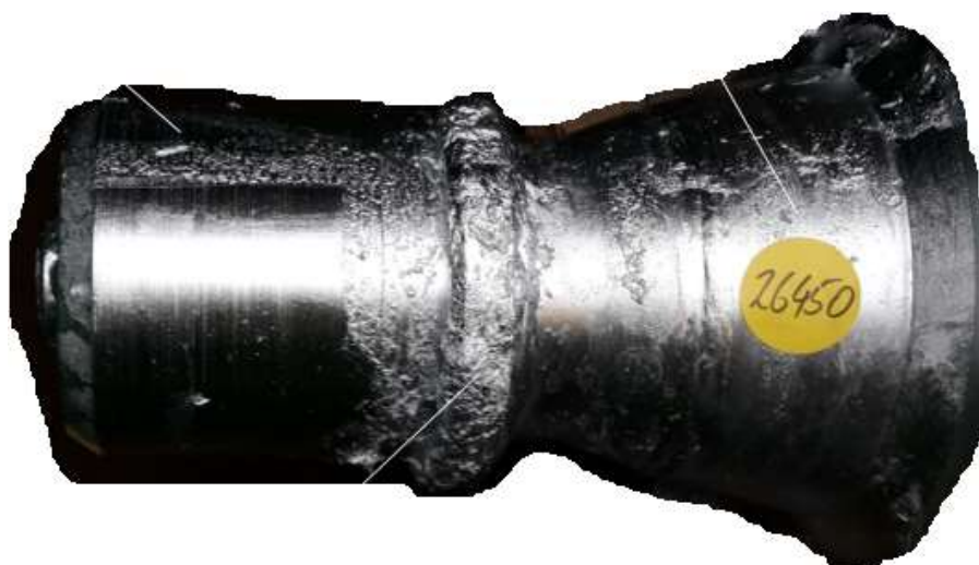
Рисунок 1.4 – Изношенная шейка валка
