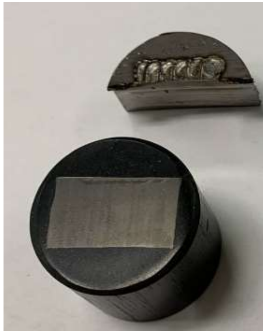
Рисунок 5.6 – Шлиф после проплавления слоя, нанесенного детонационным напылением для металлографического исследования
