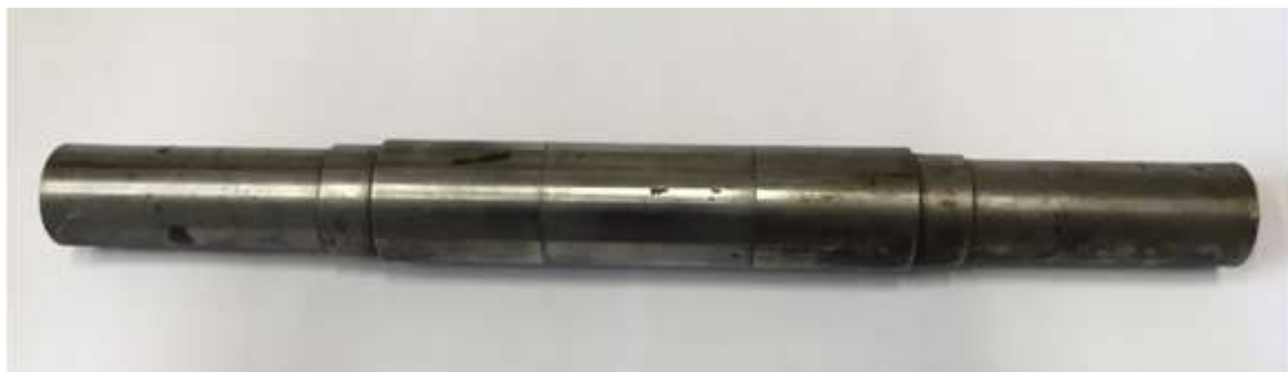
Рисунок 4.15 – Валок для холодной прокатки
