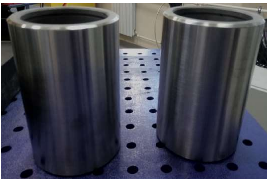
Рисунок 4.32 – Ролики ЛСО после проточки на токарном станке технологического слоя
