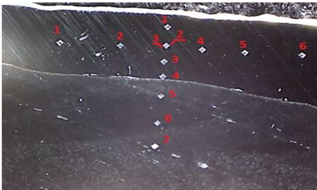
Рисунок 4.29 – Схема измерения микротвердости (x50)
