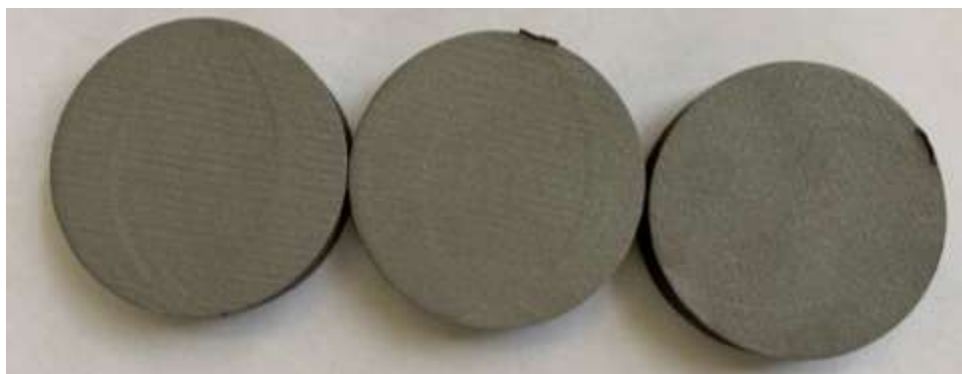
Рисунок 5.2 – Образцы (подложка) из марки стали 40Х
