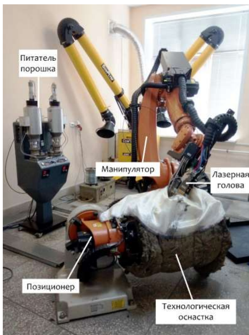
Рисунок 2.1. Лазерный комплекс с технологической оснасткой.
