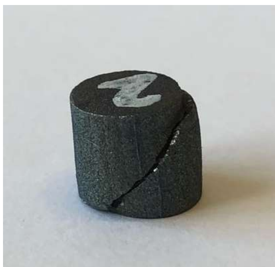
Рисунок 4.16 – Разрушение образцов по диагонали.
