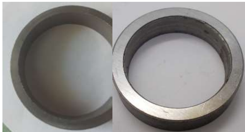
Рисунок 28 – Итоговый результат напыления: а – до напыления; б – после напыления и механической обработки
