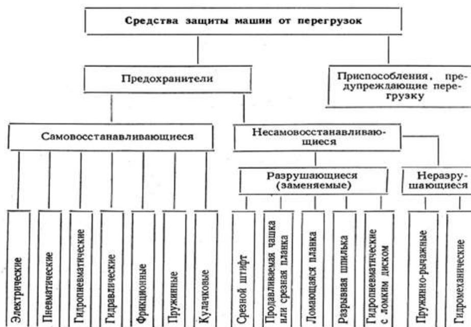
Рисунок. 1.1. Классификация средств защиты машин от перегрузки
