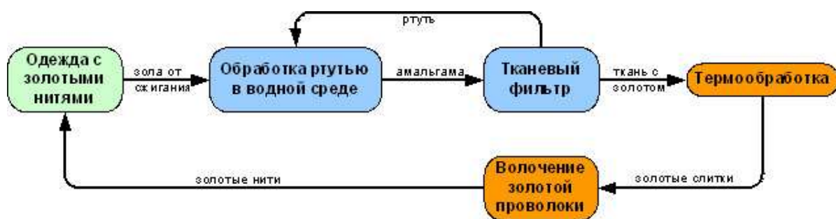
Рисунок 1.1. Использование ртути для рециклинга золотой проволоки
